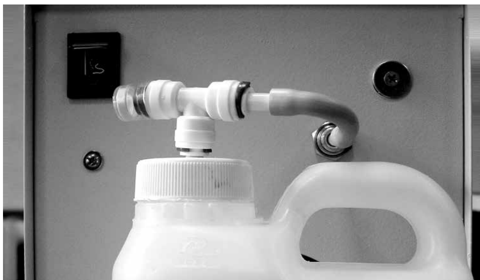
Фото 3. Подсоединение заборного устройства на корпусе распылителя (аэрозольного генератора)
